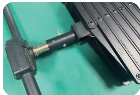
图8 杆控灯弓连接示意图
