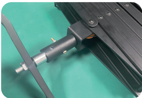
图7 U型架连接示意图
