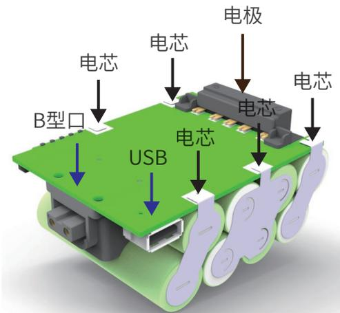
电池内部“无导线”装配工艺
