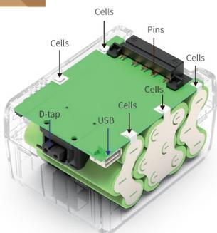
视威迷你V口电池均创新采用“无导线”内部工艺, 所有的电芯、电极、B型口、USB口、电量指示灯等器件全部直接跟主板焊接在一起, 不使用一根导线, 有效降低内阻, 最大限度发挥电池性能, 并且电路稳定, 安全可靠。
