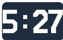
电池在摄像机或其他设备供电时，显示当前功耗电池剩余使用时间。短按按钮显示剩余电量百分比。
