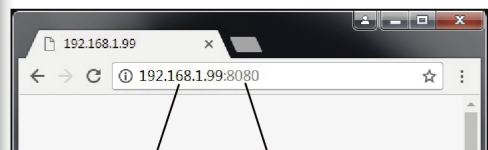
监视器IP地址 监视器端口地址
