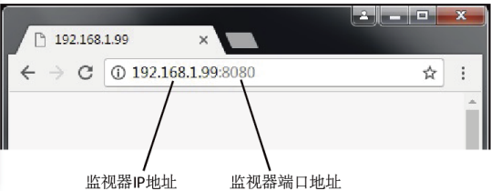
监视器IP地址 监视器端口地址
